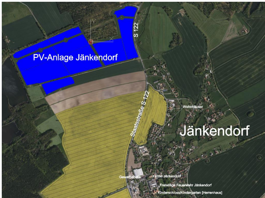
Abbildung 1: Lage des Baufelds der geplanten PV-Anlage Jänkendorf (Musterbelegung mit PV-Modultischreihen in blau eingezeichnet) sowie umliegender Orte; Quelle: bearbeitetes Kundenmaterial vor dem Hintergrund eines nach geografisch Nord ausgerichteten Luftbilds aus Bing Maps
